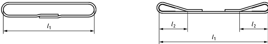
Bild 2 — Nutzlänge Endloshebeband und Nutzlänge Schlaufenhebeband
